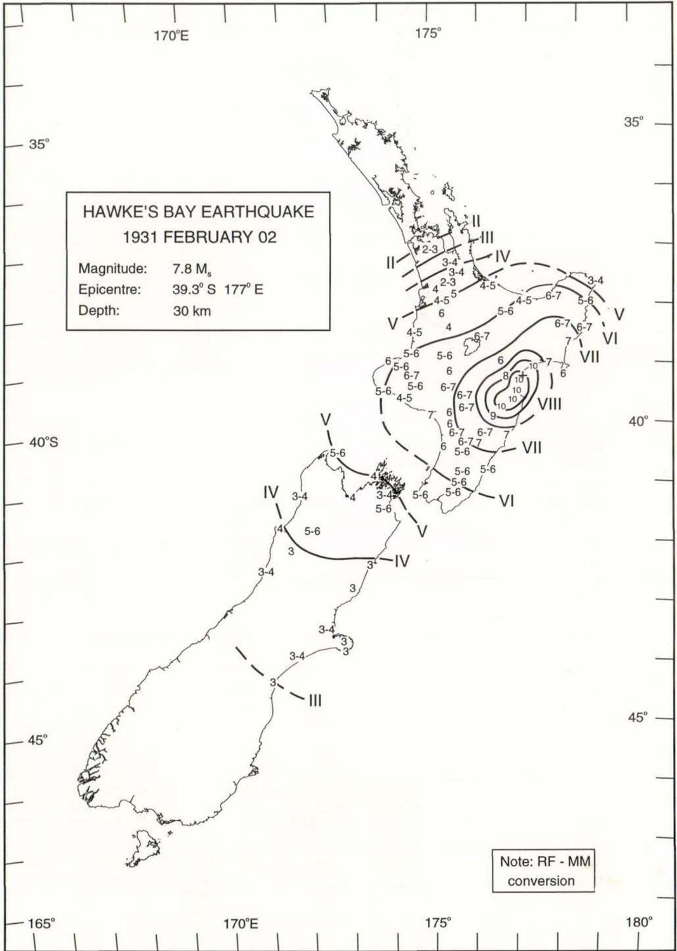
17. ISOSEISMAL MAP OF AFTERSHOCK OF THE HAWKE'S BAY EARTHQUAKE -
