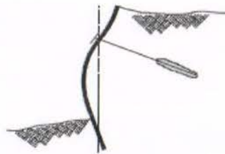
(d) Failure of wall in bending
