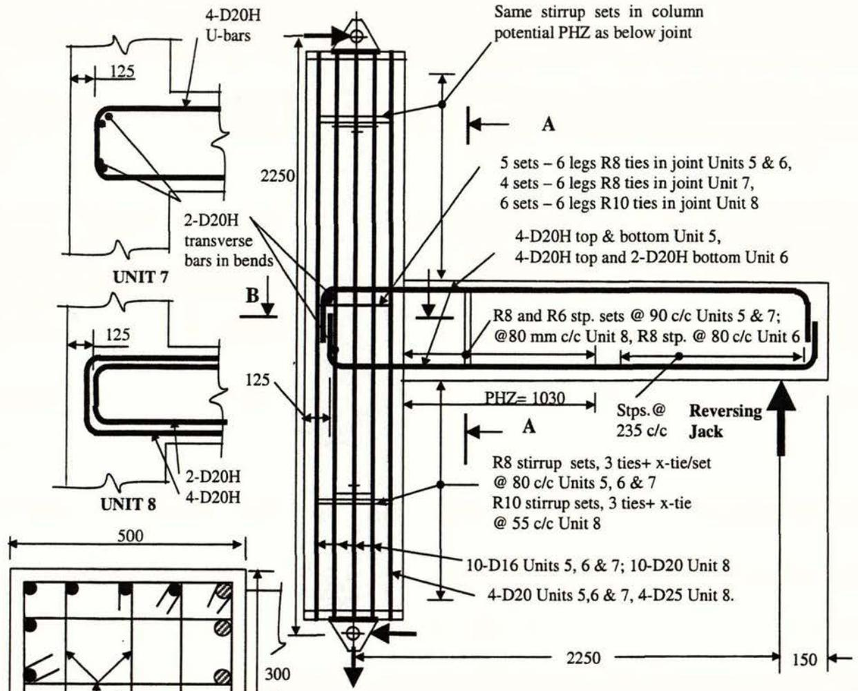
**ELEVATION ON TEST UNIT**
